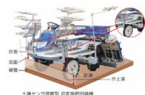
土壌センサ搭載型 可変施肥田植機
